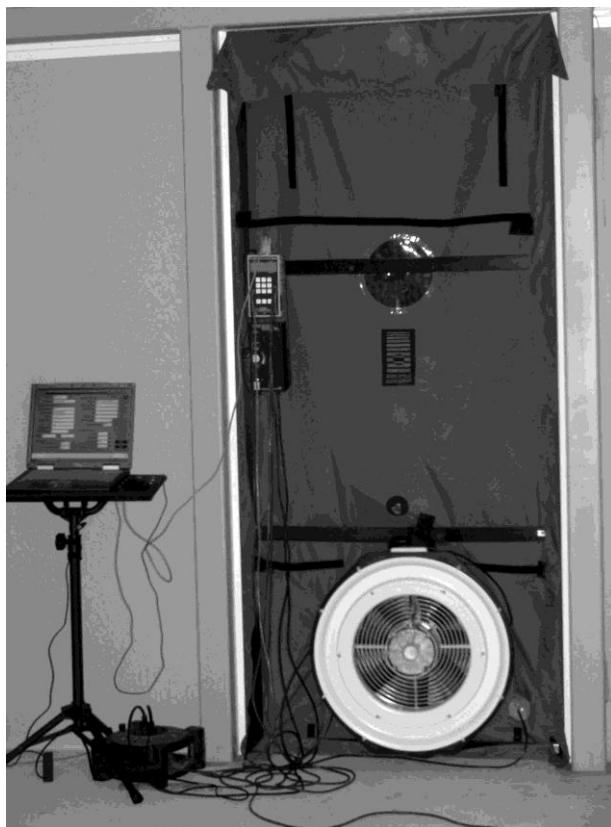
Figur 8 Utrustning för mätning av en byggnads täthet.
