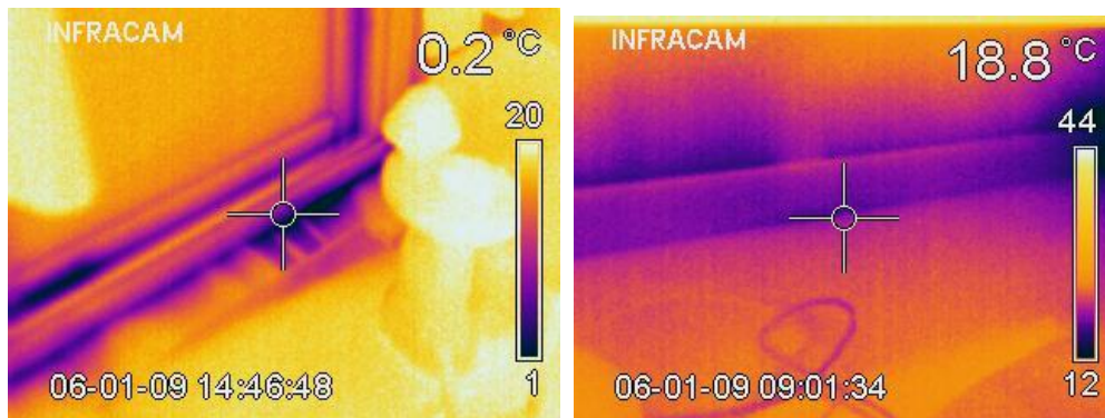
Figur 10 Termograferingsbilder (lila är kallt och vitt är varmt). Till vänster visas hur det drar vid en altandörr och till höger vid en golvlist. Vid altandörren är det endast 0,2 °C.
